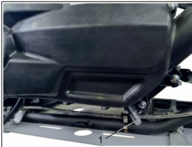
1. Сливная пробка кожуха приводного ремня.
